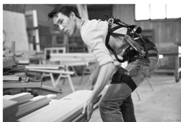
**Esoscheletri ad energia cinetica, non motorizzati (cioè non robotizzati).**
